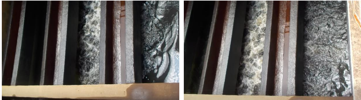
a) Início da lavagem com ar
