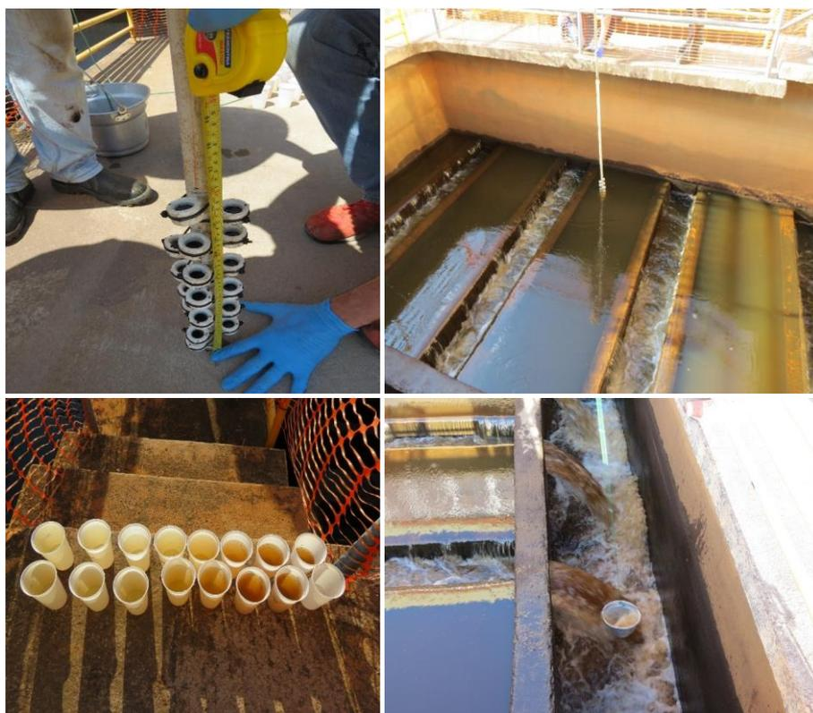
Figura 3.3 – Fotos dos ensaios de avaliação da lavagem e de expansão do meio filtrante
