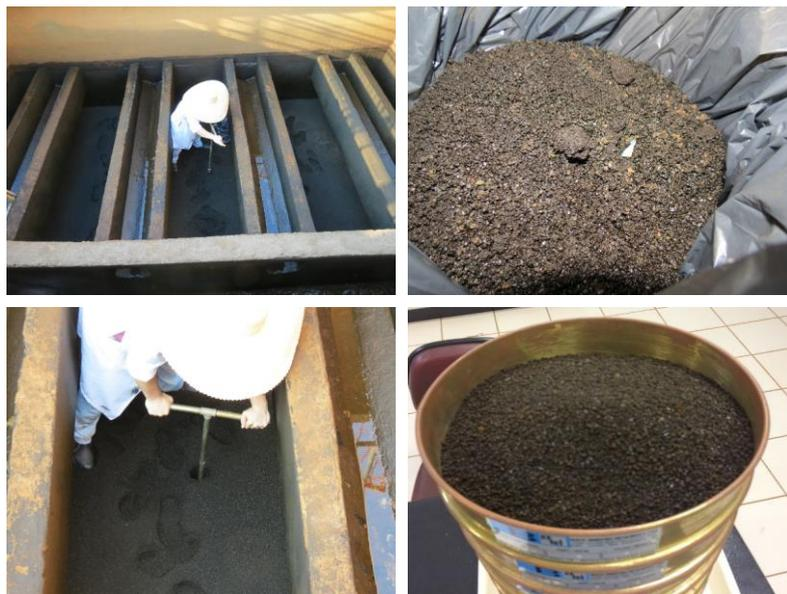
Figura 3.6 – Fotos dos ensaios de granulometria do meio filtrante e bolas de lodo
