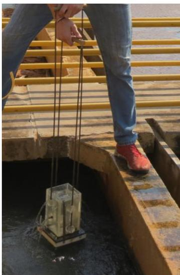
Figura 3.9 – Coletor especial de água floculada em profundidade
