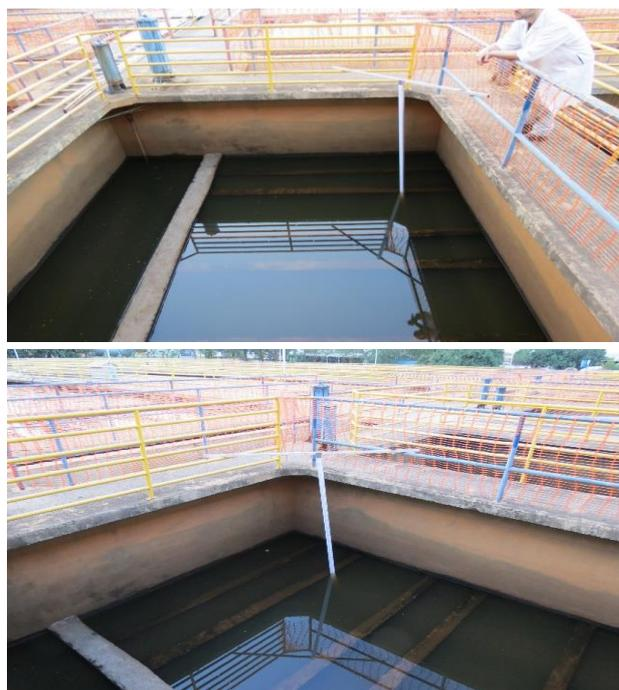
Figura 3.8 – Fotos dos ensaios de avaliação da perda de carga no meio filtrante limpo
