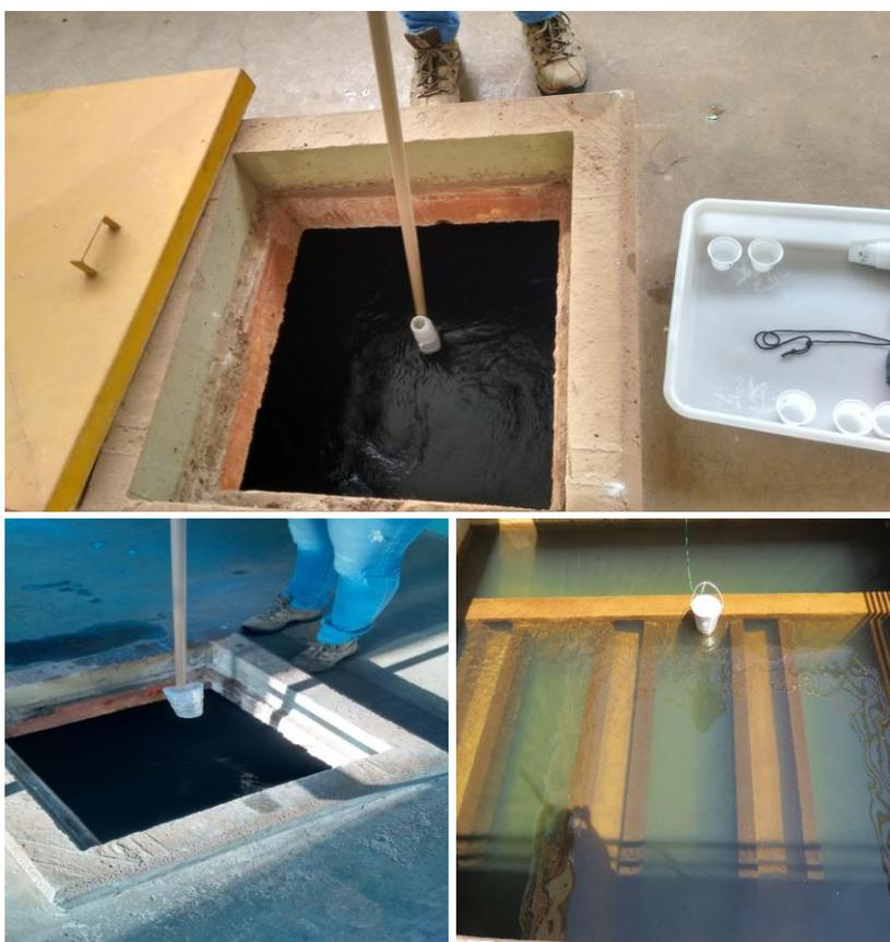
Figura 3.4 – Fotos dos ensaios de transpasse realizados nos filtros 1, 4 e 6 da ETA de Araras
