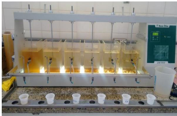
Figura 3.12 – Foto do ensaio de clarificação da água composta de lavagem do filtro 6
