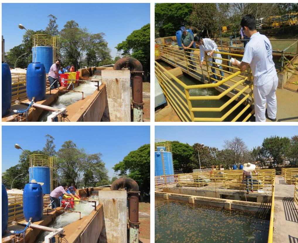
Figura 3.2 – Fotos do ensaio com traçadores na forma de pulso
