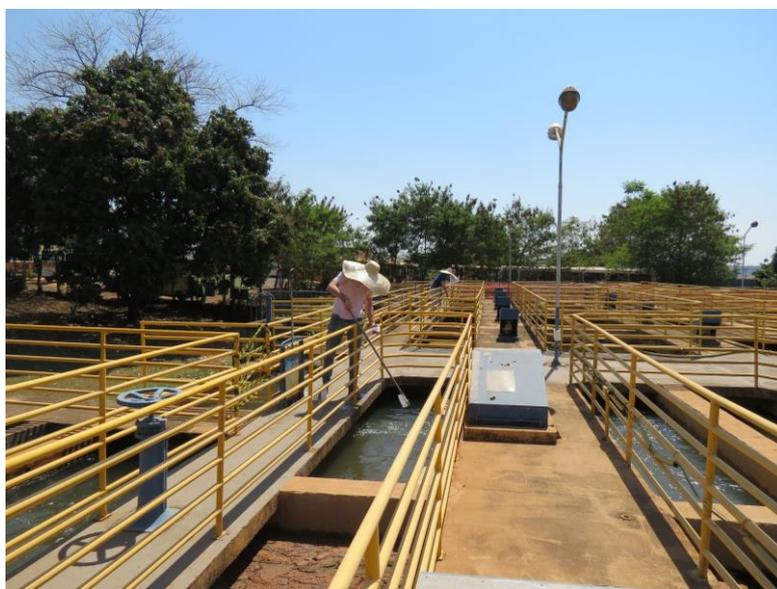
Figura 3.1 – Foto do ensaio de traçador na forma contínua – coleta de amostras nas entradas das unidades de floculação
