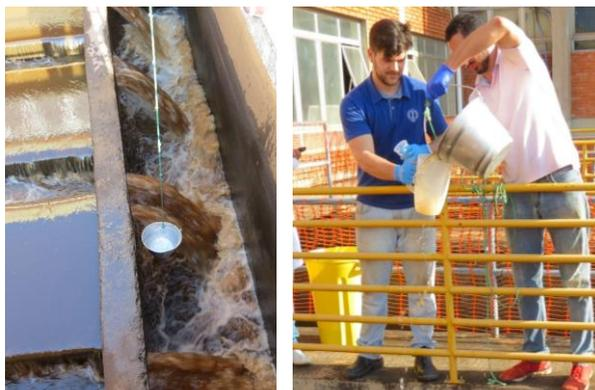
Figura 3.11 – Fotos da coleta de amostras de água de lavagem do filtro 3
