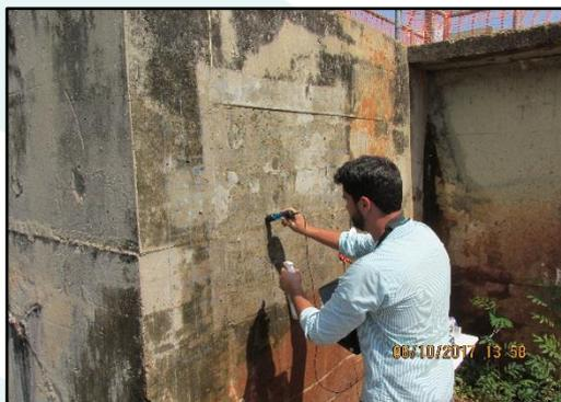
**Imagem 19:** Ensaio de Potencial de Corrosão das armaduras.
