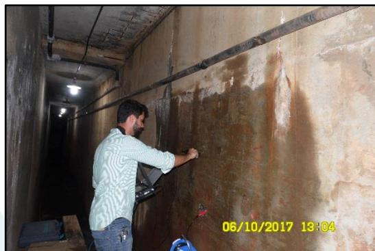
**Imagem 20:** Ensaio de Potencial de Corrosão das armaduras.
