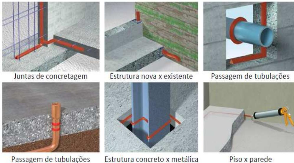
Figura 9 - Instalação de Fita Hidrofílica e/ou Selante Hidro Expansivo
