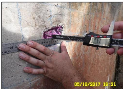
Imagem 6: Ensaio de Carbonatação.
