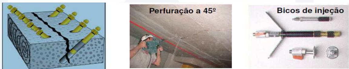
Figura 4 – Ilustração da Instalação dos Bicos de Injeção
