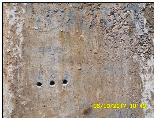
**Imagem 18:** Locais onde foram retiradas as amostras para ensaio de teor de cloretos.
