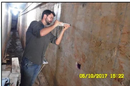
Imagem 21: Ensaio de Esclerometria.
