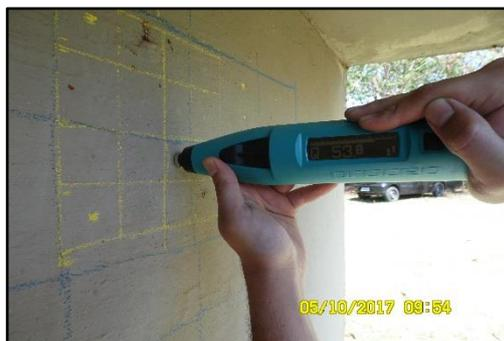
Imagem 22: Ensaio de Esclerometria.
