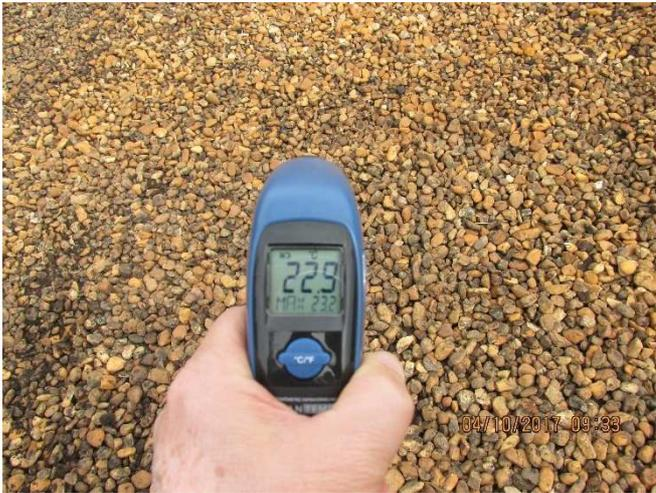
Figura 15 - Temperatura da laje de cobertura do reservatório
