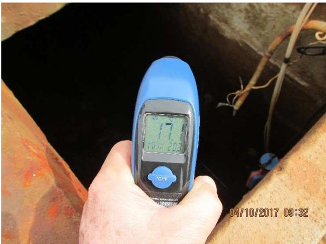
Figura 13 - Temperatura da parede do reservatório
